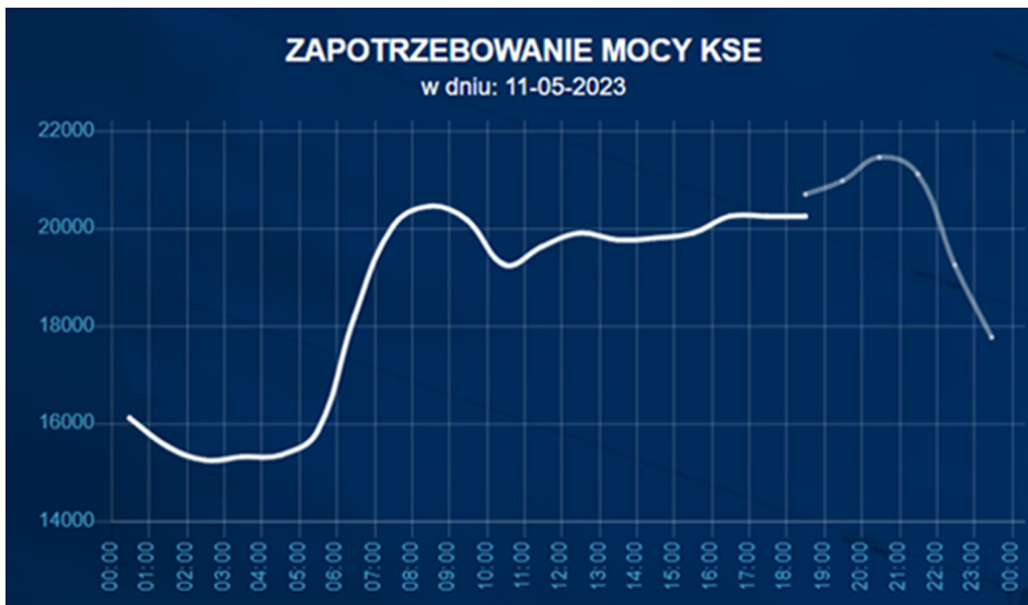
Rysunek 3. Dobowy wykres zmian zapotrzebowania na moc w krajowym systemie elektroenergetycznym
